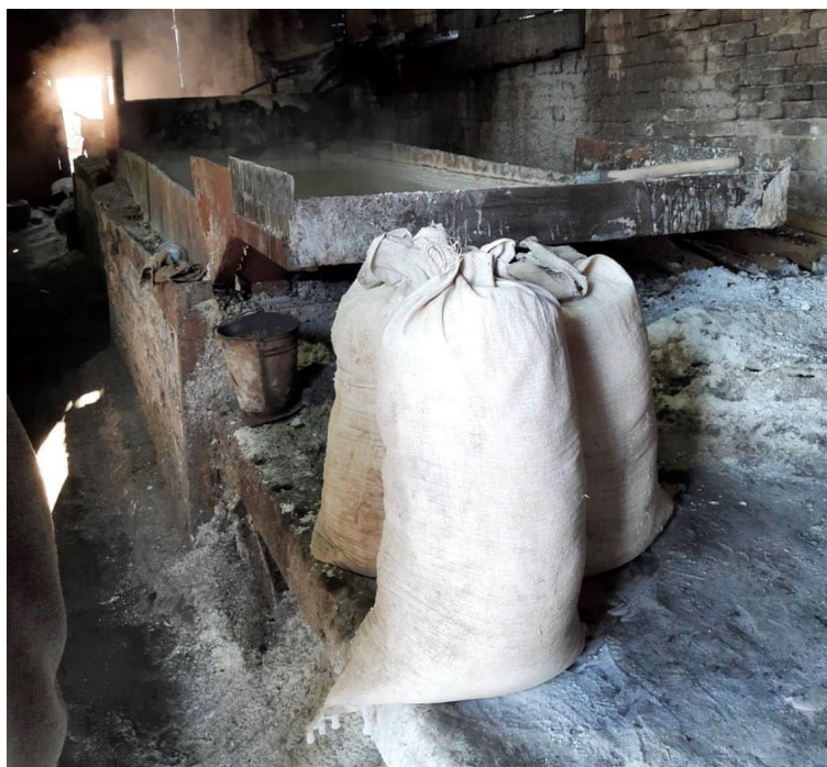
Рис. 2. Процес кристалізації солі
